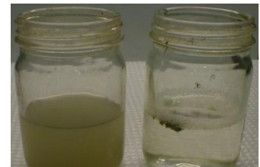
Left: DAF Influent Right: GEM Effluent
