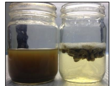
Left: DAF Influent Right: GEM Effluent
